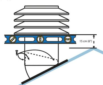
Monter la fixation du solin pour avoir un angle de niveau à 90°. Installez la tête du ventilateur en vous assurant que le ventilateur soit bien au niveau. Vissez le cube du ventilateur à la base.
