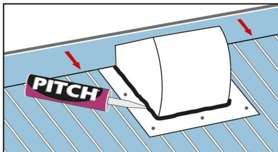
Installez la base en glissant sous le faîte la partie du haut et fixez solidement le solin (la base) avec des vis à tôle en s'assurant que la gorge du solin soit bien centrée avec l'ouverture. Une fois la base installée, ne pas oublier de toujours étancher le joint de la base du cube en mettant un cordon de calfeutrant.
