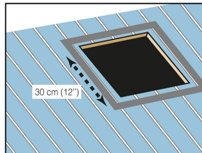
Percez un trou dans un coin du tracé avec une perceuse, assez grand pour y introduire la larme d'une scie sauteuse. Avec la scie sauteuse, découpez le pourtour de votre tracé fait à la craie. Une fois le trou effectué, installez et collez un ruban d'étanchéité pour tôle autour de l'ouverture que vous venez de faire.
