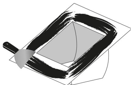
Appliquez généreusement du scellant de calfeutrage type CR20 en-dessous du solin afin de rendre étanche l'espace entre le toit et le ventilateur.
