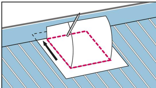
Glissez la partie du haut de la base en-dessous du recouvrement du faîte de toit. Tracer à l'aide d'une craie l'intérieur du solin, en s'assurant d'avoir le solin parallèle au faîte du toit. La première ailette à partir du bas de la base doit dépasser d'au moins 30 cm (6") le faîte du toit.
