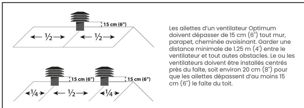
Les ailettes d'un ventilateur Optimum doivent dépasser de 15 cm (6") tout mur, parapet, cheminée avoisinant. Garder une distance minimale de 1.25 m (4') entre le ventilateur et tout autres obstacles. Le ou les ventilateurs doivent être installés centrés près du faîte, soit environ 20 cm (8") pour que les ailettes dépassent d'au moins 15 cm (6") le faîte du toit.
