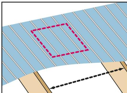
Déterminez la position de l'unité. Localisez dans l'entretoit où sont situés les fermes de toit (trust) et positionnez entre les fermes de toit.
