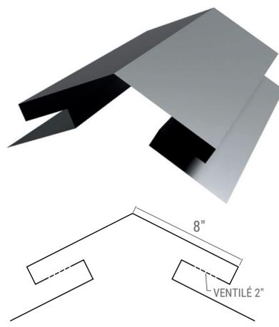
JONCTION TOIT-TOIT AVEC « J » & INSERTION
